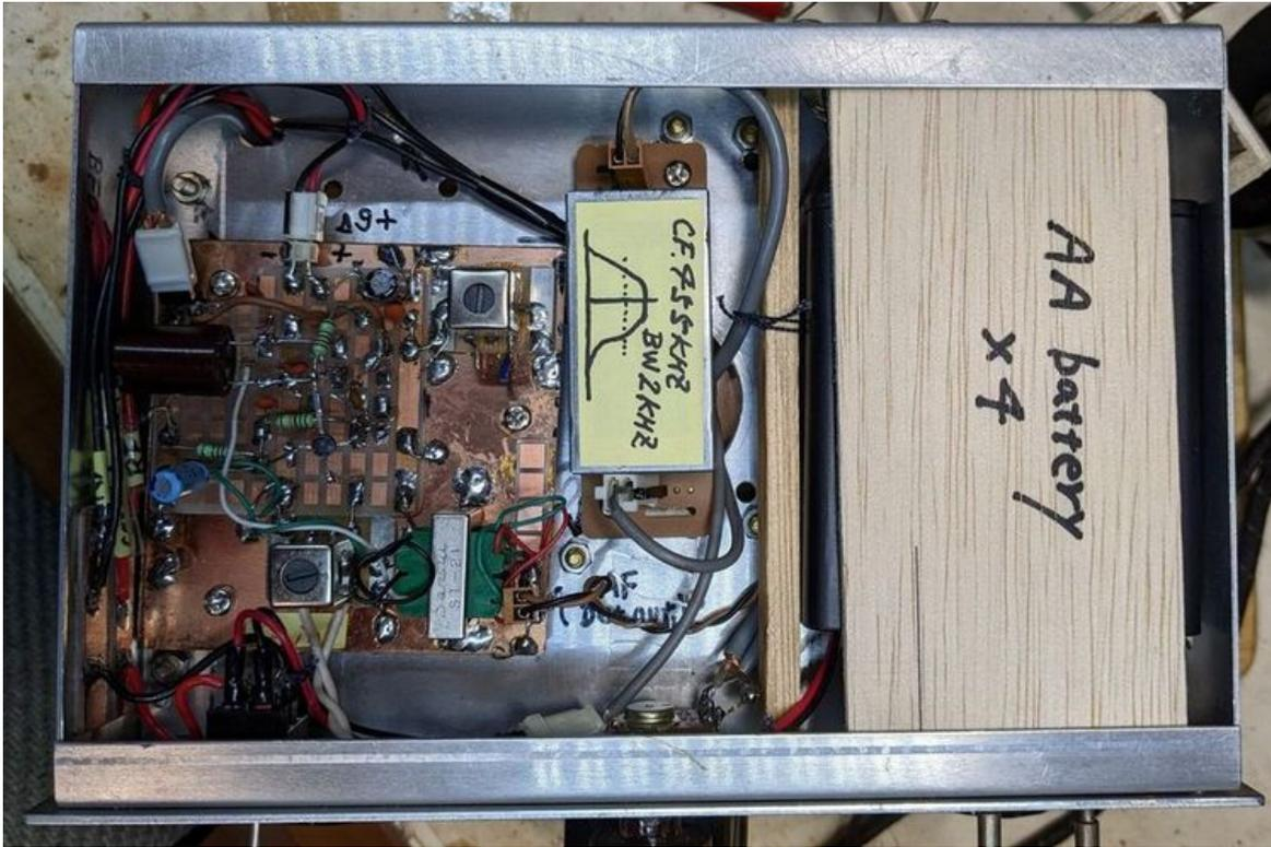
基板ブロック間の信号はDIPピッチ2Pコネクタを付けた同軸で相互接続をしてあります。
